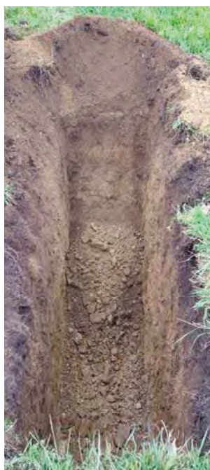
Foto.40. Interior de la calicata C-13.
