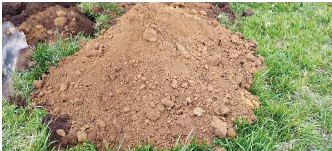
Foto. 9. Acopio del material de excavación de la calicata C-3.
