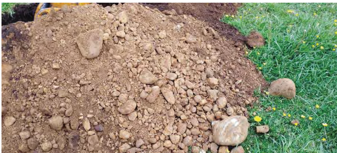
Foto.12. Acopio del material de excavación de la calicata C-4.
